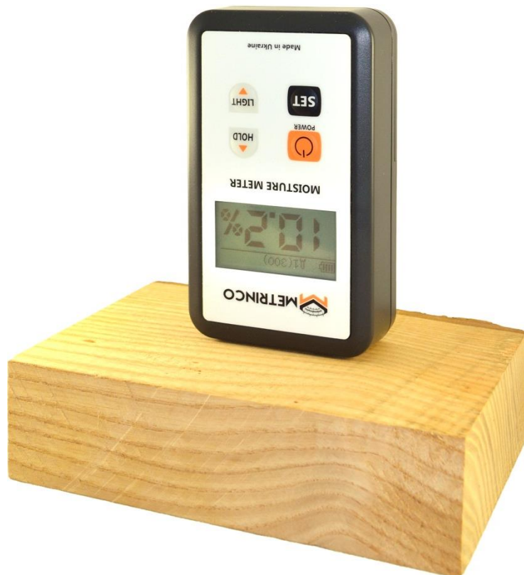
Рисунок 5 – Правильне розташування сенсора приладу на деревині
