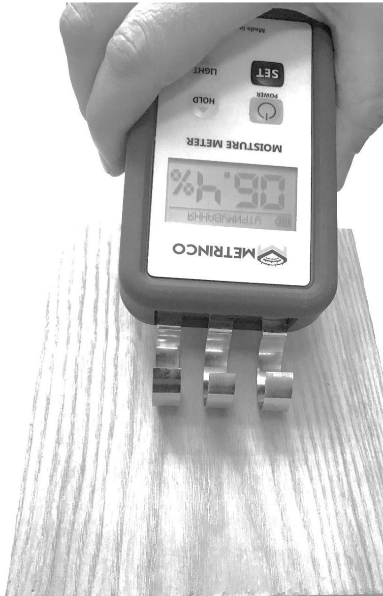
Рисунок 5 – Правильне розташування сенсора приладу на деревині
