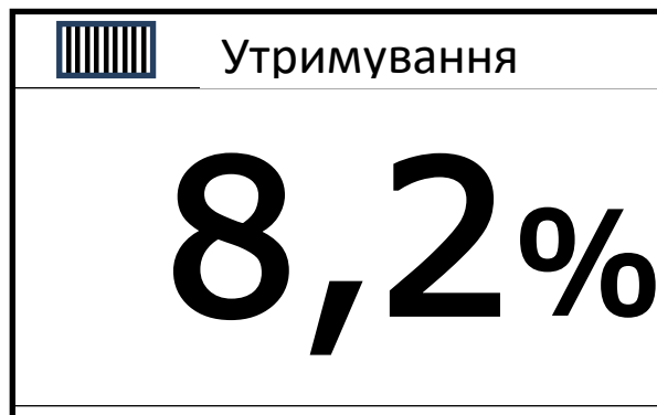
Рисунок 5 – Екран приладу в режимі утримання результату
