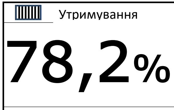
Рисунок 5 – Екран приладу в режимі утримування результату
