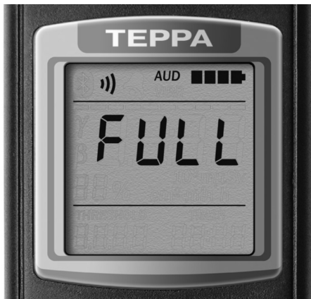
Рисунок 9 – РКІ дозиметра (початок підрежиму збереження результату вимірювання – в енергонезалежній пам'яті немає вільного місця)
