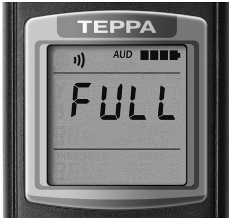
Рисунок 19 – РКІ дозиметра (початок підрежиму збереження результату вимірювання – в енергонезалежній пам'яті немає вільного місця)
