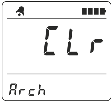
Рисунок 30 – РКІ радіометра (підрежим стирання результатів вимірювань, що збережені в енергонезалежній пам'яті)
